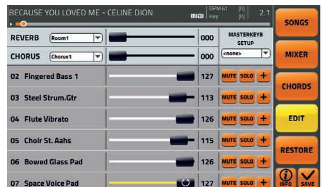
Links des Tracknamens befindet sich das Symbol, dass das Aufrufen der Seite Edit 2 ermöglicht, von dort können alle Trackparameter kontrolliert werden. Auf dieser Seite kann das Instrument geändert werden und an einigen Parametern gearbeitet werden, wie Pan Pot, Reverb, Chorus, Velocity und Transpose.
