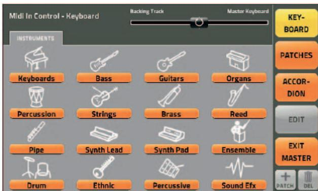
In diesem Modus auch „Instrumente“ genannt, kann ein einzelner Klang eingestellt werden, der auf der Tastatur verwendet werden soll. Dieser Bildschirm ist besonders nützlich für alle, die in „Echtzeit“ den Klang, den Sie Live verwenden, ändern möchten.
