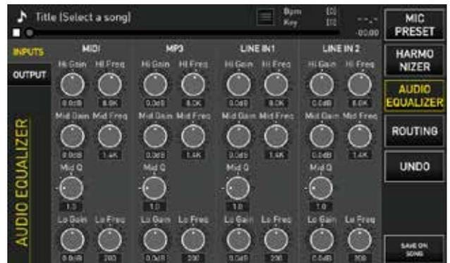
Im Bereich Audio Equalizer können Sie mit hochwertigen Equalizern arbeiten, die auf die Backing-Tracks und auf die Audioeingänge 1 und 2 einwirken und abschließend mit einem 10-Band-Equalizer, der die gesamte Audioausgabe von Merish5 bestimmt.
