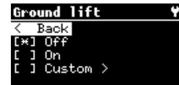
L'option Ground LIFT Custom : permet de choisir les canaux à connecter au GROUND. Appuyer sur ENTER pour activer la connexion à la masse. Appuyer à nouveau sur Enter pour désactiver le raccordement. Tourner l'Alpha Dial pour sélectionner le canal d'intervention.
