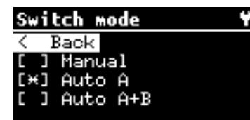
Wählen Sie die Funktion Switch Mode, um festzulegen, in welchem Modus die Umschaltung zwischen den beiden an GO.8 angeschlossenen Maschinen erfolgen soll.
