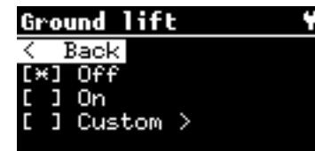
La opción Ground LIFT Custom: permite elegir qué canales conectar al GROUND. Pulse ENTER para activar la conexión a tierra. Vuelva a pulsar Enter para desactivar la conexión. Gire Alpha Dial para seleccionar el canal de intervención.
