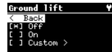
Ground LIFT Custom: Hier können Sie auswählen, welche Kanäle mit GROUND verbunden werden sollen. Drücken Sie ENTER, um die Masseverbindung zu aktivieren. Drücken Sie erneut die Eingabetaste, um die Verbindung zu deaktivieren. Drehen Sie den Alpha-Dial, um den Interventionskanal auszuwählen.
