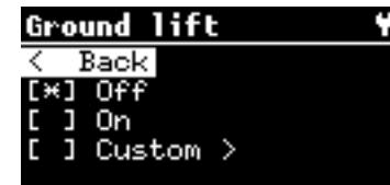
L'opzione Ground LIFT Custom: consente di scegliere quali canali collegare al GROUND. Premere ENTER per attivare il collegamento alla massa. Premere enter nuovamente per disattivare il collegamento. Ruotare l'Alpha Dial per selezionare il canale di intervento.
