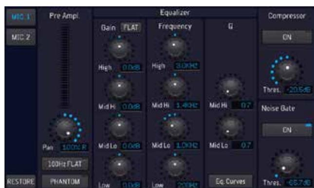
Cet écran permet d'effectuer des réglages pour les deux entrées de microphone. MIC 1 ou 2 est sélectionné en haut. Il est possible de régler la préamplification et de sélectionner le mode fantôme si nécessaire. Il est possible de régler le PAN (Réglage panoramique) et d'activer un filtre de 100 Hz à l'aide d'un bouton spécifique. Ce filtre élimine les bruits de fond.
