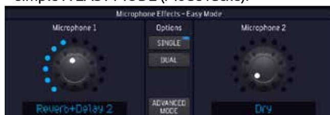
En Easy mode (Mode facile), il suffit d'agir sur le potentiomètre du canal 1 ou 2 du microphone (ou sur la molette Alpha Dial) pour modifier les réglages du microphone sans entrer dans la modification des paramètres. Tournez le potentiomètre ou la molette Alpha Dial jusqu'à ce que vous obtenez
