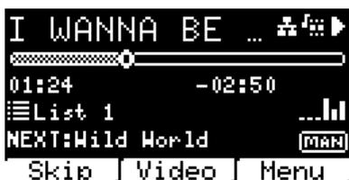
Oben steht der Titel der laufenden Datei, die Symbole auf der rechten Seite zeigen an, dass der B.BeatX mit einem Netzwerk verbunden ist, dass die laufende Datei mit einem Video verknüpft ist und dass sich die Datei in der Pausenposition befindet.
