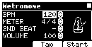
**BPM:** zeigt die gewählte Geschwindigkeit an. Sie kann mit Alpha-Dial (nach links oder rechts drehen) oder mit der TAP-Funktion geändert werden.
